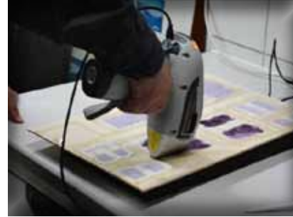
Resim 3: Taşınabilir spektrometreyi kullanarak pigmentlerden XRF spektrasının ölçülmesi
