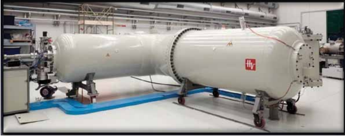
Resim 11: PIXE ve PIGE'nin uyarımı için kullanılan bir tandem hızlandırıcısı
